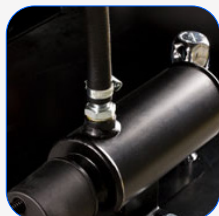
Sistema de caldeo de motor
