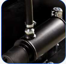
Sistema de caldeo de motor
