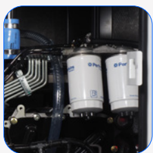
Filtro separador de partículas de combustible
