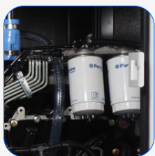
Filtro separador de partículas de combustible
