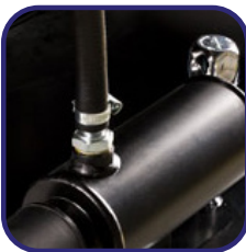
Sistema de aquecimento do motor
