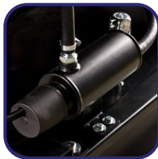
Sistema de caldeo de motor
