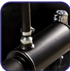
Sistema de aquecimento do motor
