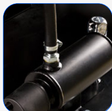
Sistema de pré-aquecimento do motor
