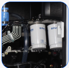
Filtro separador de partículas de combustível
