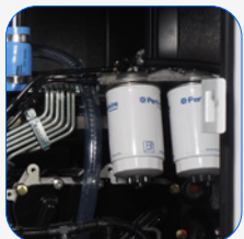
Filtro separador de partículas de combustível
