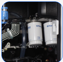
Filtro separador de partículas de combustível
