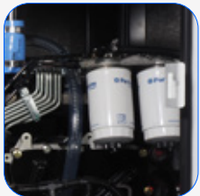
Filtro separador de partículas de combustível
