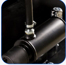
Système de préchauffage du moteur
