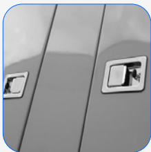
Capot complet en acier inoxydable (304)
